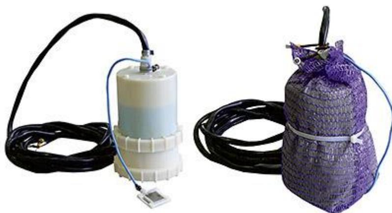
ЭНЕС-4М (электрод сравнения) предназначены для создания электролитического контакта с грунтом в схемах при определении эффективности противокоррозийной защиты подземных металлических сооружений и обеспечения работы выпрямителей катодной защиты в режиме автоматического поддержания измеряемой разности потенциалов и для измерения величины поляризационного потенциала защищенного сооружения переносными приборами.
